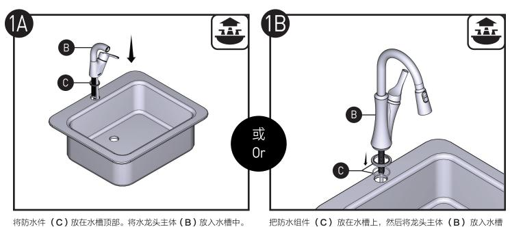
将防水件 (C) 放在水槽顶部。将水龙头主体 (B) 放入水槽中。
