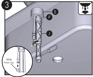
用安装螺母(F)将安装垫片(E)固定后,用套筒扳手(J)将安装螺母(F)拧紧。
