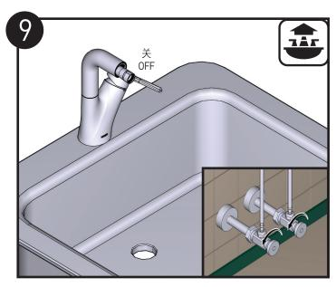
关闭水龙头,然后打开冷热水管的开关。
