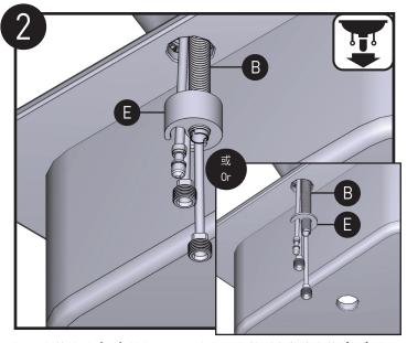
将和安装垫片(E)按如图所示的顺序安装到水龙头主体(B)上。
