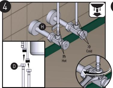
将水龙头冷热水管(D)分别正确地连接到冷热进水口。 将抽拉软管(I)从水龙头主体(B)插入安装。注意:安装时请 勿先取下抽拉软管(I)的保护盖。
