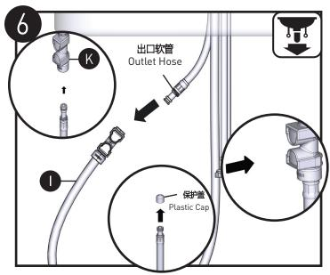
拔掉抽拉软管(I)的保护盖。用快速接头(K)连接抽拉软管(I)与龙头出水管。尽可能往内推,直到听到"咔嗒"声。向下 拉测试安装是否牢固。注:如果想拆下抽拉软管(1)可按下开关 同时向下拉。
