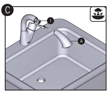
将喷嘴(A)和抽拉软管(I)重新连接。
