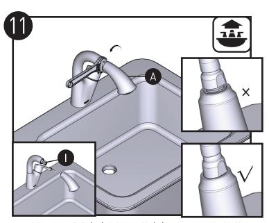
用手连接并拧紧喷嘴(A)与抽拉软管(I),如果没有达到安装效果,可用活动扳手锁紧。**注意:不需过于用力,以防损坏喷嘴**。
