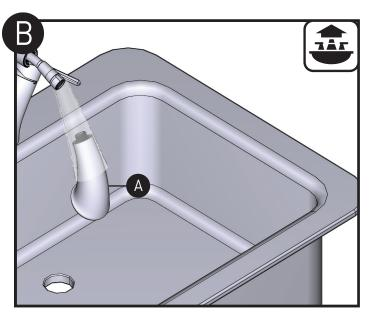
用水冲洗喷嘴 (A),清洗至无可见碎屑等堵塞物。关闭水龙头,重新安装喷嘴 (A)。
