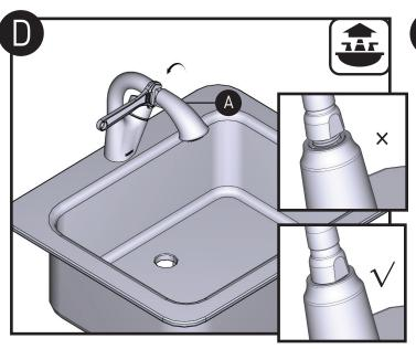
重新用手连接并拧紧喷嘴(A)与抽拉软管(I),如果没有达到安装效果,可用活动扳手锁紧。**注意:不需过于用力,以防损坏喷嘴。**
