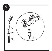
确保花洒软管(8)的两端都带有密封垫片(7)。将花洒软管的一端连接花洒(6),另一端连接阀体的花洒连接头。
