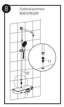
将连接头(11)安装在阀体(1)上, 然后将淋浴杆连接到阀体(1)
