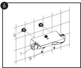
特殊之字接头安装 将阀体(1)套入之字接头(5),用固定螺丝(9)锁紧。
